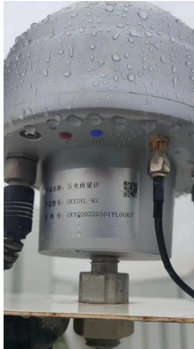
图 2.2-4 压电雨量计（无能源棒）安装示意图
